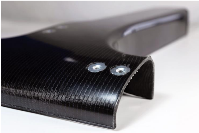
Bild 2: Ein Novum stellt der Einsatz eines materialschonenden UKP-Lasers dar, der die Textilien bearbeitet, ohne diese thermisch zu schädigen. © Institut für Textiltechnik (ITA) der RWTH Aachen University, Aachen.
